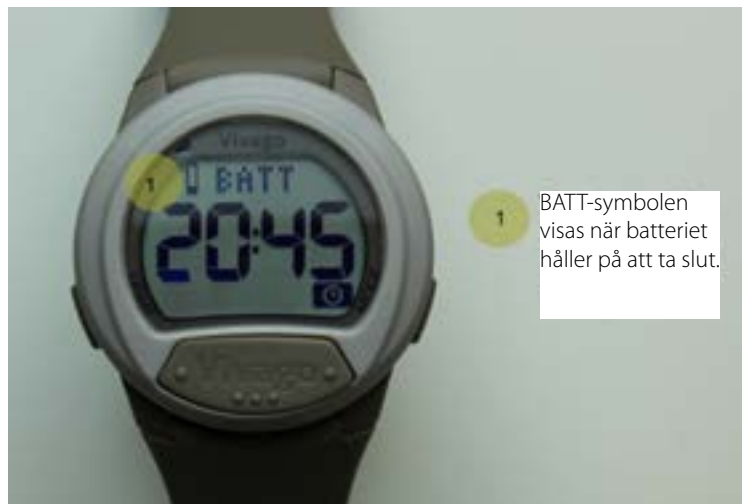
Bild 5a Vivago CARE -klockan visar en batterisymbol när batteriet är nästan tomt.
